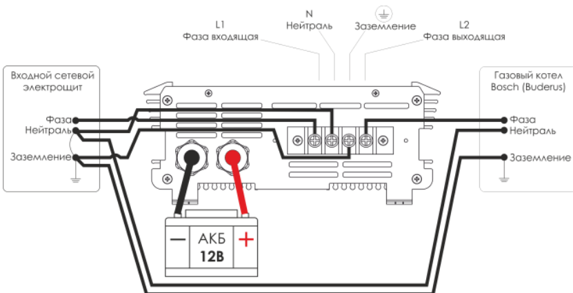
Схема подключения ИБПС к газовому котлу Bosch (Buderus)
