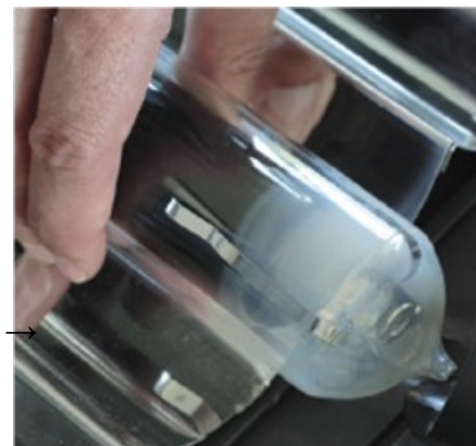
газопоглотитель разрушен, трубка неисправная
