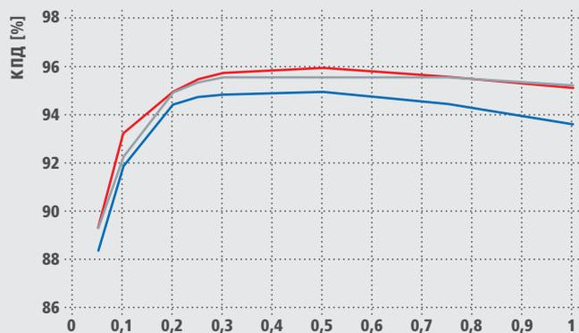
СТАНДАРТНАЯ МОЩНОСТЬ НА ВЫХОДЕ  $P_{AC}/P_{AC,R}$  ■ 165 В ■ 330 В ■ 440 В
